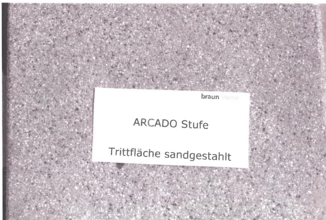
Bild 1. Die zu prüfende Oberfläche **ARCADO Stufe, sandgestrahlt**, im aufgebauten Zustand.
